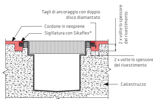
Connessione al drenaggio
