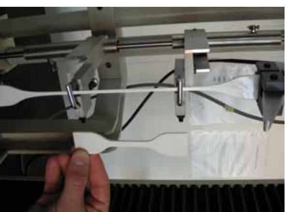
La membrana impermeabilizzante della linea MasterSeal M 689 durante il test di trazione secondo ASTM D638. Si noti l'elevatissimo allungamento elastico del materiale.
