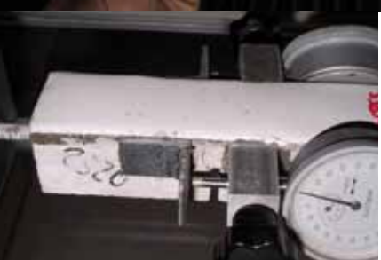
La membrana impermeabilizzante della linea MasterSeal M 689 durante il test di trazione secondo ASTM D638. Si noti l'elevatissimo allungamento elastico del materiale.
